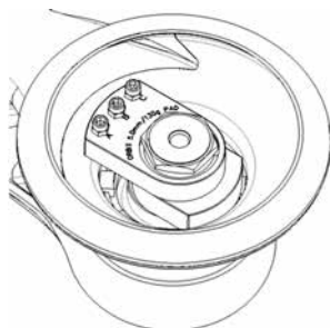
2. Maskinkonfiguration för användning med pad saver/slipplatta.
